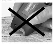
Die Aufsetzlinie der Keilspitze soll möglichst im rechten Winkel zur Textzeile geführt werden.
